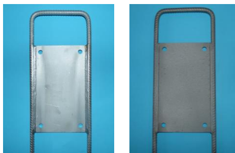
Abb. 3: Halbfabrikate, links gebeizt, rechts gestrahlt
