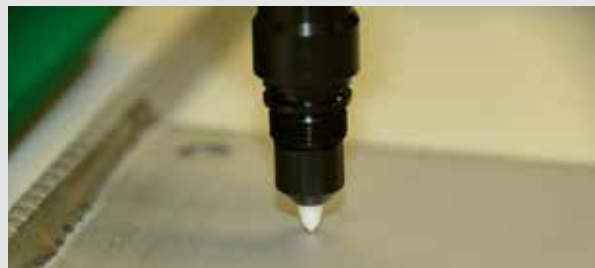
Abb. 1: Auf der Stahloberfläche aufgesetzte EC-Pen Messspitze
