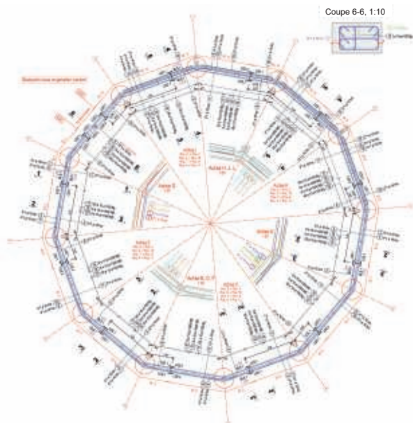
Vue en plan (anneau d'armature en bleu) : huit anneaux d'armature répartis en quatre lits reprennent les forces d'écartement du toit.
