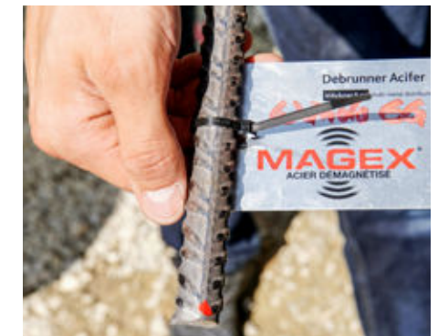
Zudem ist jeder Eisenbund präzise beschriftet (links) und mit einer silbrigen Plakette gekennzeichnet.
