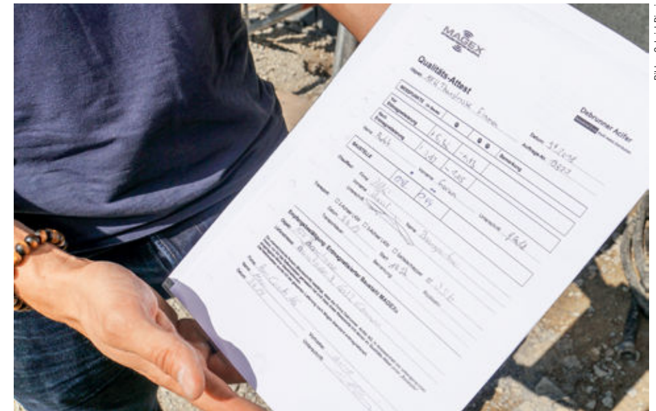
Für jede Charge des sogenannten Magex-Stahls gibt es ein Qualitäts-Attest: Darin werden die Messwerte vor und nach der Entmagnetisierung und beim Abladen auf der Baustelle festgehalten.
