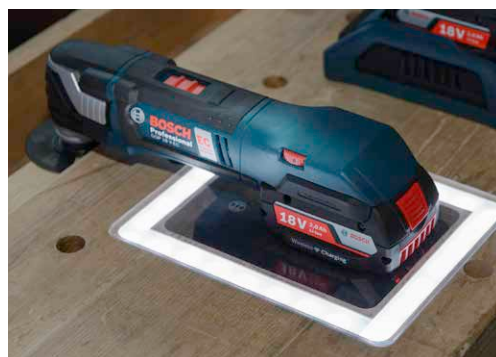
Chargeur encastré dans un établi.
